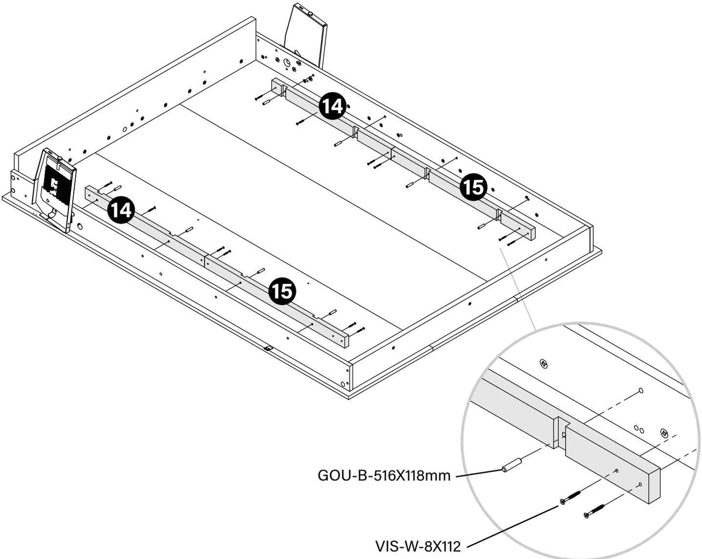
Utiliser les goujons de bois pour positionner le support sur le côté de matelas.
