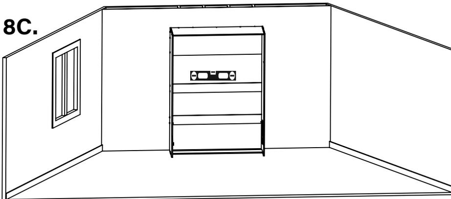
Placer le niveau sur le cabinet et corriger la verticale et l'horizontale au besoin. S'assurer que le cabinet est au niveau dans les deux sens, sinon la fermeture du lit sera compromise. /
