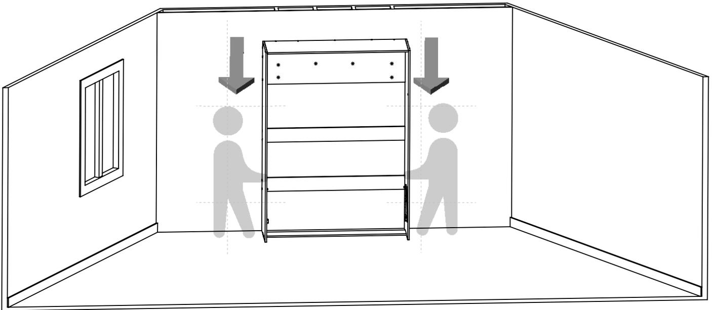
De chaque côté du cabinet, tirer simultanément sur les côtés du cabinet pour tenter de l'arracher du mur.
