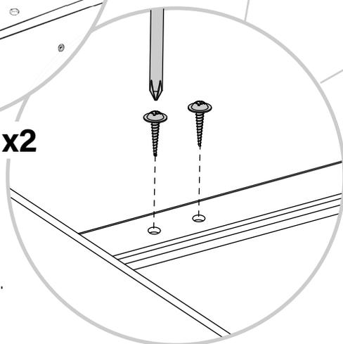
Aligner les trous des 2 parties du mécanisme avec un petit tournevis afin de bien pouvoir visser les vis.
