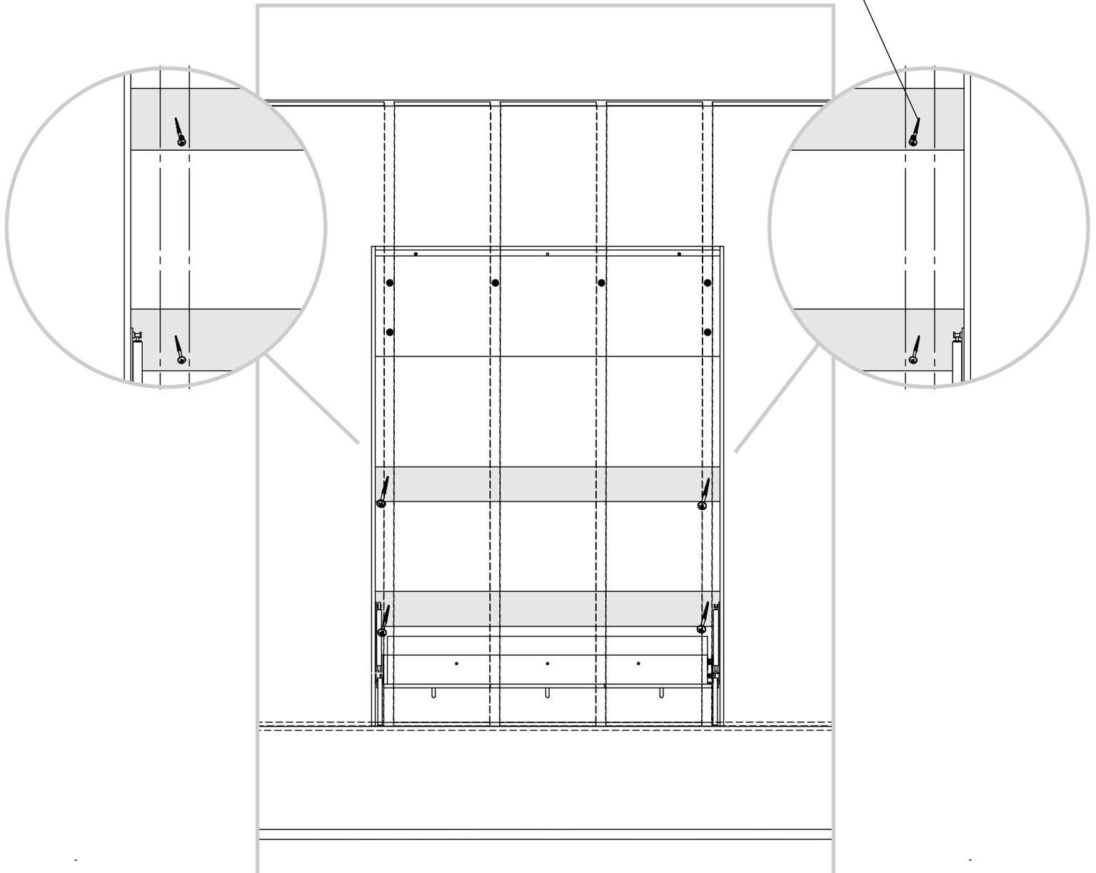
Le lit ouvert, fixer le centre du cabinet avec un minimum de 4 vis dans les traverses du centre du cabinet. S'assurer d'être fixé dans les montants du mur. Utiliser l'ancrage adéquat selon le type de mur.
