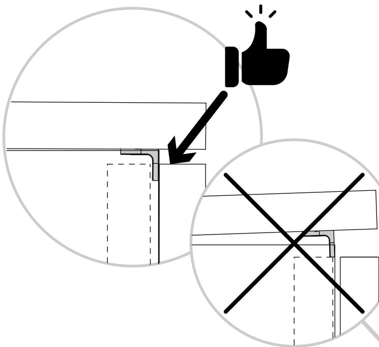
Si les clips de sécurité empêchent le panneau de dessus de se fermer correctement, ajuster la position des aimants pour que le panneau de dessus se ferme correctement.
